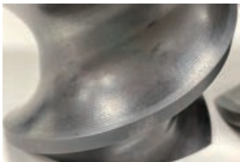
200tonの生産でも 劣化が見られない MZ材のスクリー表面
