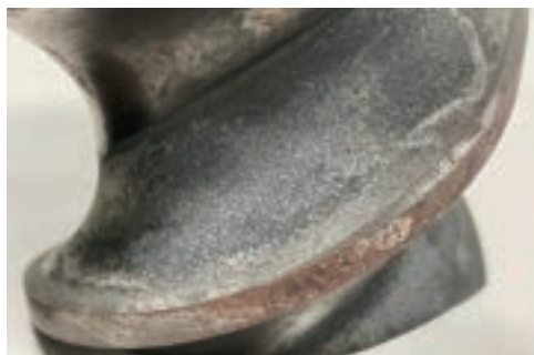
20tonの生産で 腐食摩耗した 合金工具鋼製のスクリー表面
