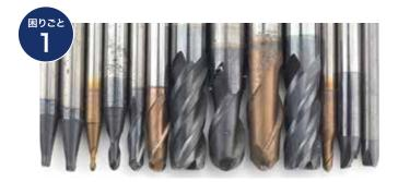
欠損やチッピングによる不良、手直し口スの発生
