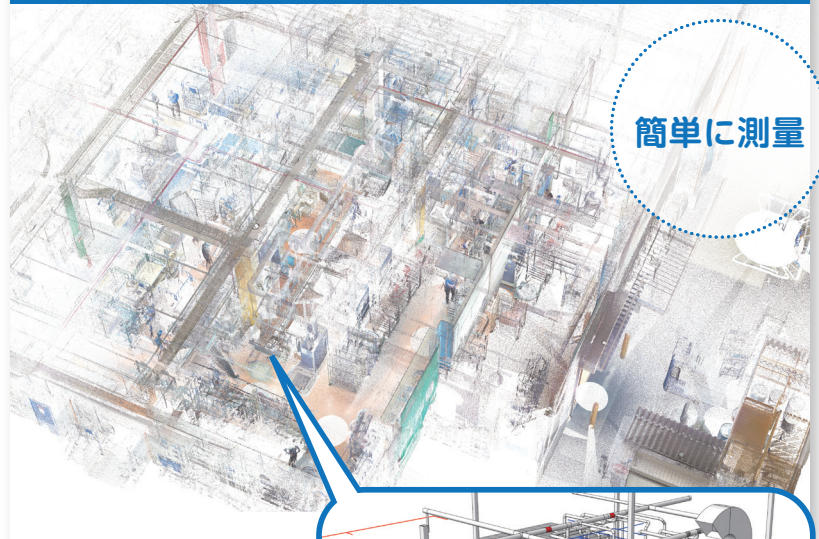
3Dレーザースキャンで測量したお客様の工場点群データ
