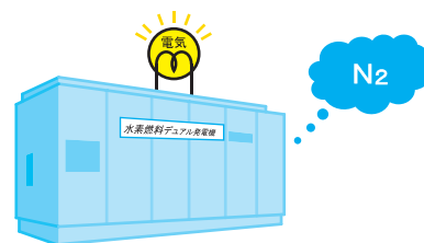
水素燃料デュアル発電機
