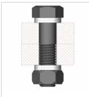
貫通穴に使用する六角ボルト、両側を固定
