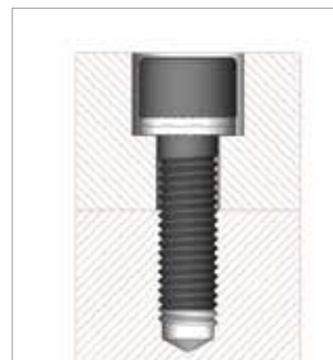
座ぐり穴に固定された六角穴付ボルト
