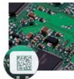
マシンビジョンは、電子製品のアセンブリの高速なアライメントやトレーサビリティを最新の小型化部品やフレキシブル基盤においても実現します。
